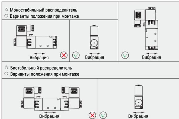
6. Чтобы предотвратить попадание конденсата, масла и т.д. в разъем, следует обращать внимание на положение монтажа распределителя.
