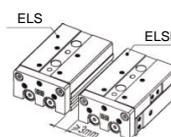
5. Обязательно используйте дроссели с обратным клапаном чтобы обеспечить скорость перемещения приода не более 500 мм/с
