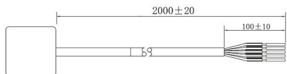
Для обеспечения необходимой степени защиты кабель выполнен встроенным в корпус датчика. Слишком большое усилие на отключение кабеля может привести к его повреждению.
