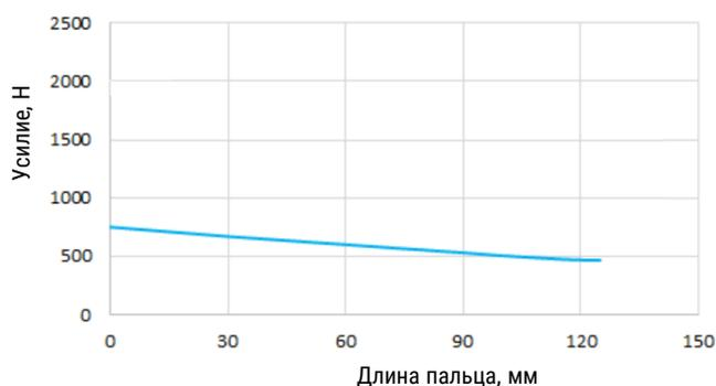
Усилие захвата меняется в зависимости от расстояния до точки захвата.
