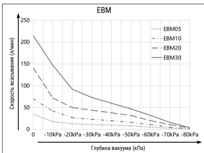
**EBX** Скорость всасывания в зависимости от глубины вакуума
