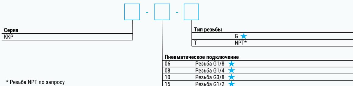
**Пример заказа:** Клапан быстрого выхлопа серии ККР, присоединение 1/4, G резьба.
