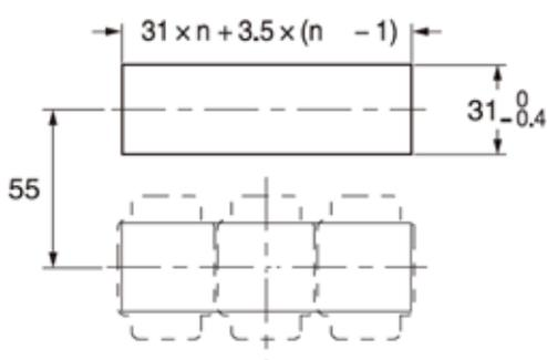
Установка нескольких датчиков вертикально
