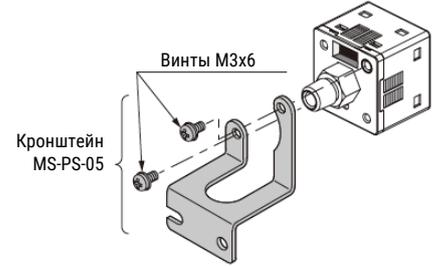
Примечание: Для соединения датчика с монтажным кронштейном используются винты M3x6, момент затяжки для них не должен превышать 0,5 Нм.
