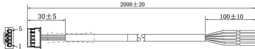
Для подключения датчика используйте кабель с разъёмом, входящий в комплект поставки. При отсоединении кабеля тяните только за разъём, в противном случае кабель может быть повреждён.
