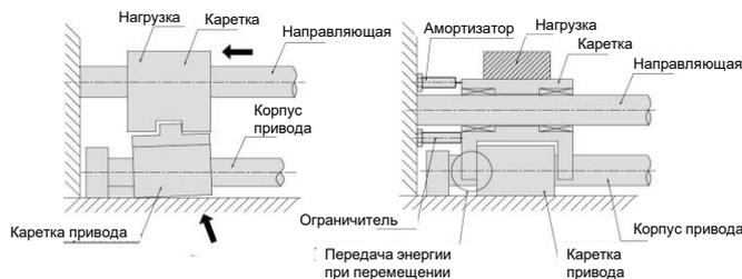
5.4. При вертикальном перемещении останов с помощью пневмосхемы не может использоваться, поскольку прикреплённая к каретке нагрузка воздействует на каретку, что может привести к нарушению магнитной связи между кареткой и поршнем привода.
