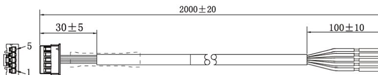
Для подключения датчика используйте кабель с разъёмом, входящий в комплект поставки. При отсоединении кабеля тяните только за разъём, в противном случае кабель может быть повреждён.
