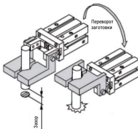
8. При операции вставки заготовки, заготовка должна быть отцентрирована. Скорость должна быть снижена, чтобы гарантировать безопасное и безударное перемещение заготовки.
