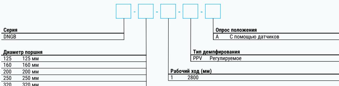
**Пример заказа:** серия DNGB, диаметр поршня 200 мм, ход штока 500 мм, с пневматическим регулируемым демпфированием, с возможностью опроса положений.
