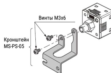
Примечание: Для соединения датчика с монтажным кронштейном используются винты М3х6, момент затяжки для них не должен превышать 0,5 Нм.
