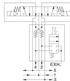
**Важно!** В пневмосистеме всегда присутствуют утечки, поэтому плата не может использоваться как модуль безопасного останова.
