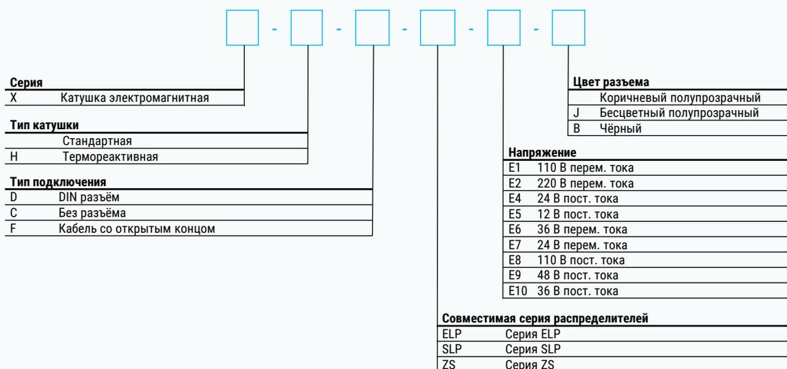
**Пример заказа:** Катушка для клапана серии ELP, без разъёма, напряжение 24 В пост. тока.
