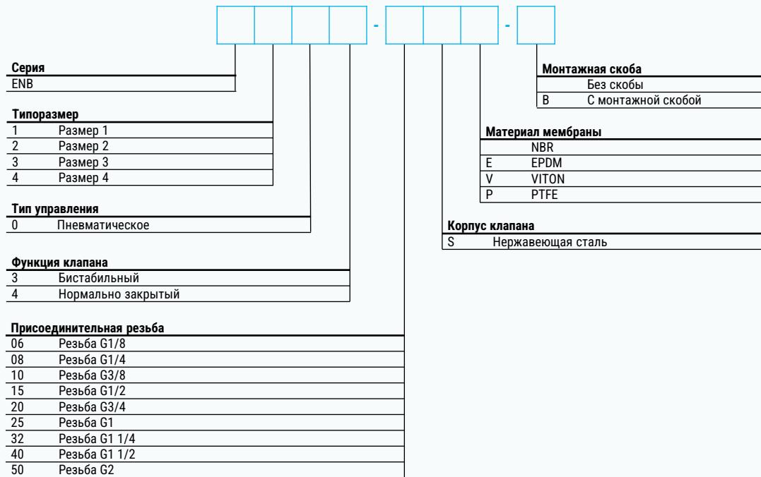
**Пример заказа:** серия ENB, типоразмер 4, пневматическое управление, нормально закрытый, резьба G1, корпус – SS304, уплотнения – EPDM.
