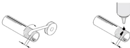
2. Избегайте избыточного использования жидкого клея для резьбы. Не допускайте его попадания внутрь привода, в противном случае после его высыхания привод может потерять свою функциональность.
