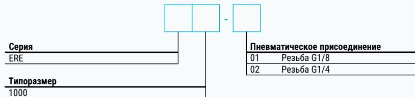
**Пример заказа:** Регулятор давления серии ERE, типоразмер 1000, пневматическое присоединение G1/8
