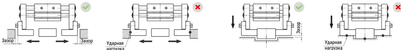
8. Если заготовка находится не на оси захвата, это приводит к появлению дополнительного усилия на губки захвата. При пуско-наладочных работах уровень давления должен повышаться плавно чтобы убедиться в отсутствии внешних воздействий на захват.
