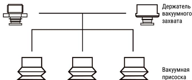
Конструкция вакуумного захвата SZB позволяет заменить присоску по мере износа.
