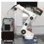
02 Стенд "Роботизированная ячейка для сварки"
